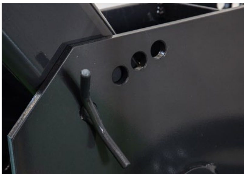
Dettaglio della foratura per la variazione della distanza tra le ruote
