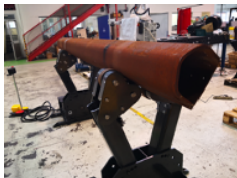
Dettaglio della foratura per la variazione della distanza tra le ruote
