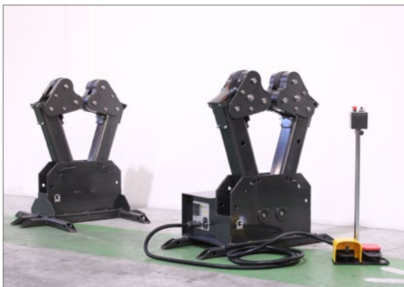
R025 in esecuzione speciale con rulli basculanti, per rotazione di tubolari poligonali
